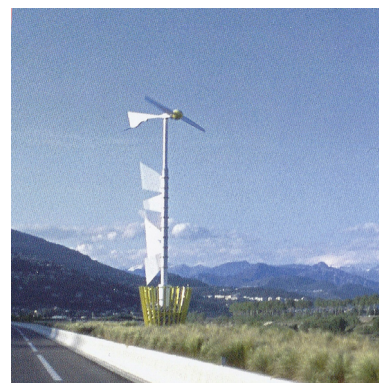
Exemple [9] le long de la RD6202 (basse vallée du Var dans les Alpes Maritimes), éolienne assurant l'arrosage des plantations
