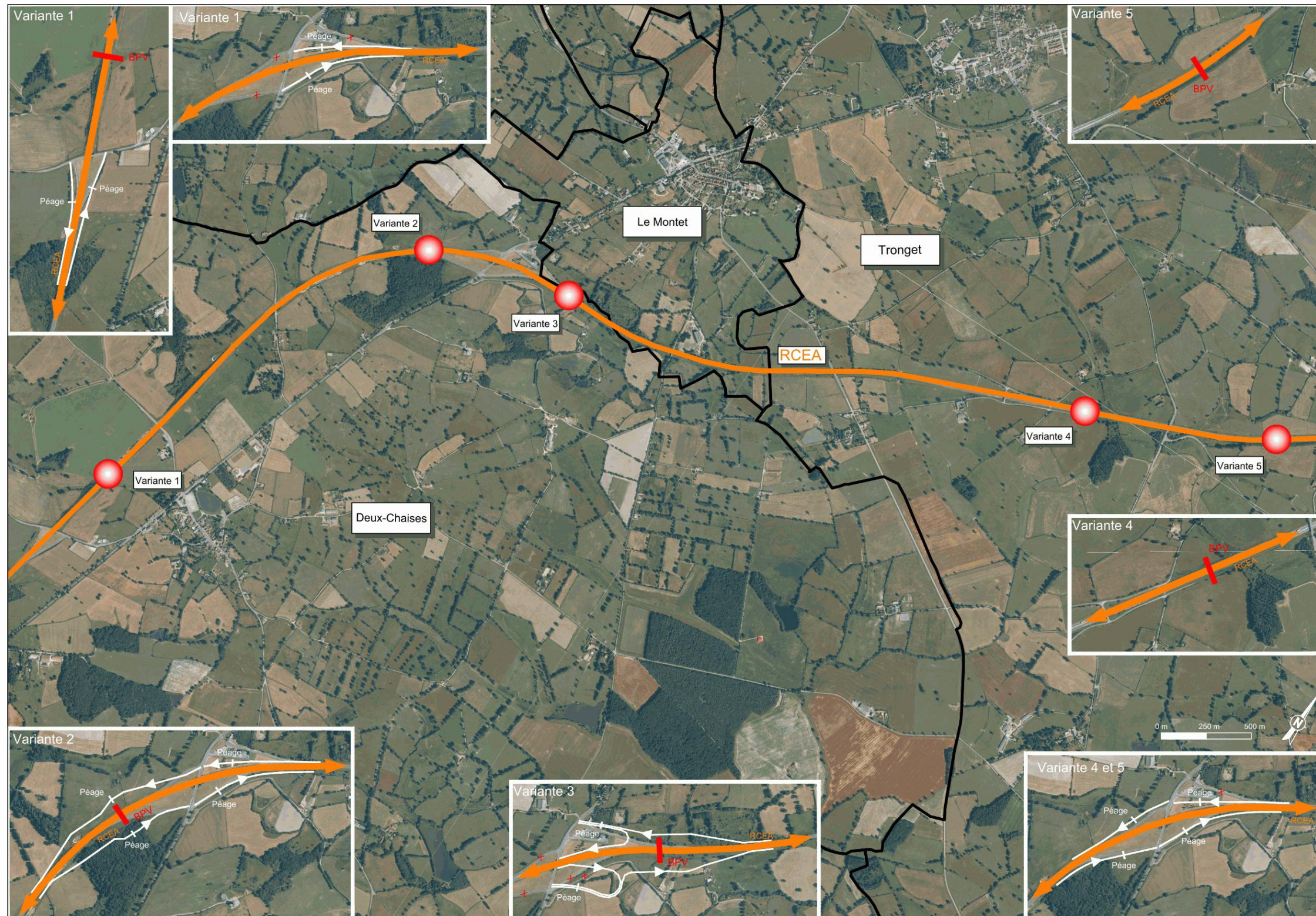
Figure 5 : localisation des variantes d'implantation de la Barrière de péage Pleine Voie du Montet
