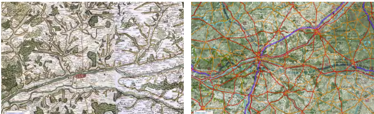
Fig. 137 : Les voiries dans le Val de Loire, une trame héritée de l'histoire : deux axes longeant la Loire, des itinéraires convergeant vers les villes principales qui sont autant de points de franchissement. (Carte de Cassini du XVIII ème siècle et carte actuelle, IGN Géoportail 2009)
