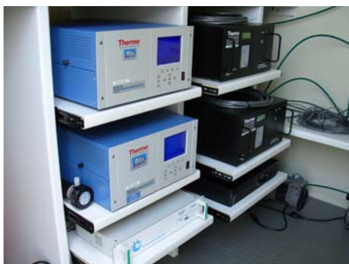
Figure 14 Analyseurs automatiques pour la mesure des polluants gazeux et particulaires réglementaires+
