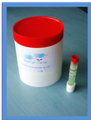
Figure 9 : Échantillonneur passif pour le dioxyde d'azote ( \text{NO}_2 ) et sa boîte de protection contre les intempéries (Source : Qualitair Corse)
