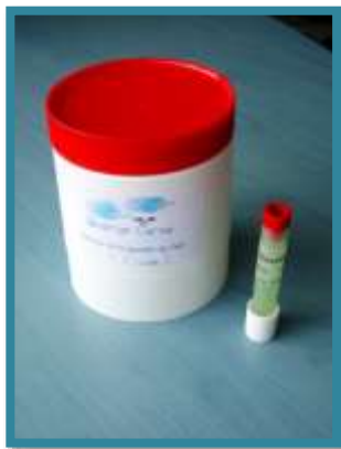
Figure 1 : Échantillonneur passif pour le dioxyde d'azote ( \text{NO}_2 ) et sa boîte de protection contre les intempéries (Source : Qualitair Corse)
