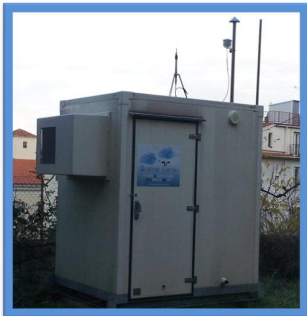
Figure 2 : Station de mesure de la qualité de l'air
