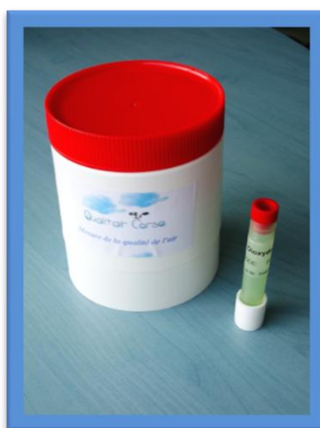
Figure 9 : Échantillonneur passif pour le dioxyde d'azote (NO 2 ) et sa boîte de protection contre les intempéries (Source : Qualitair Corse)
