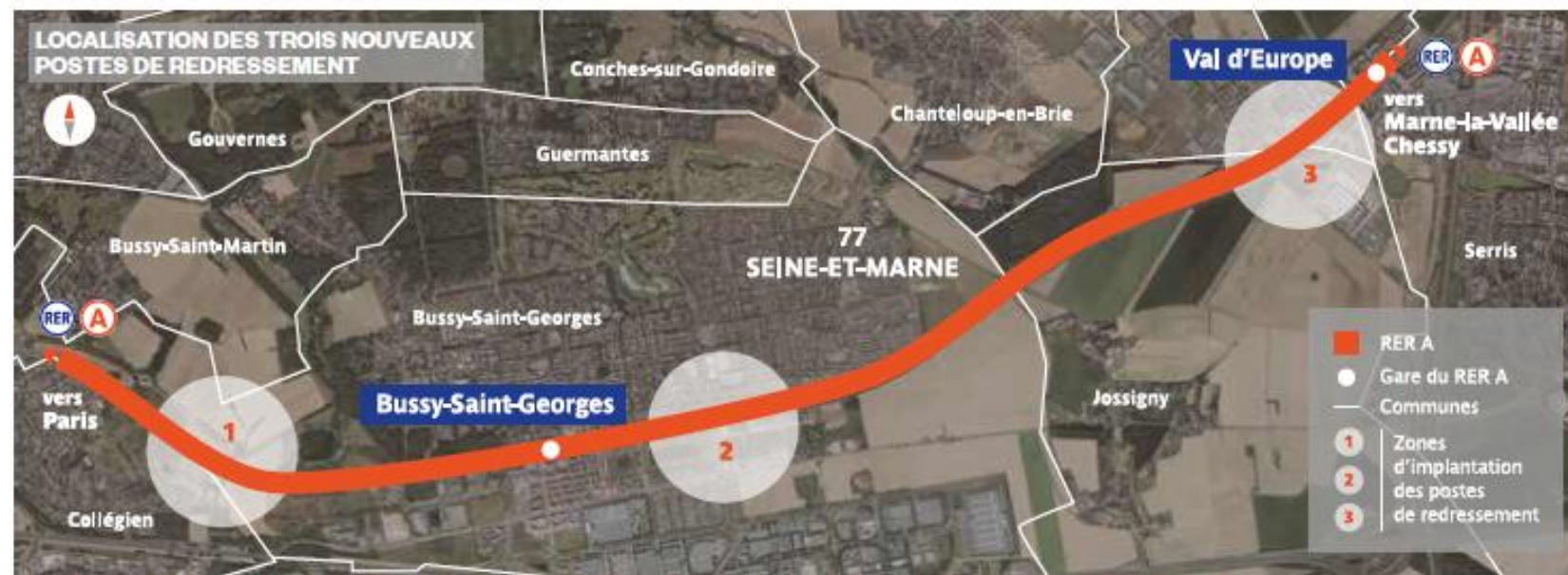
* Un poste de redressement transforme le courant fourni par ERDF en courant utilisable par les RER (1500 V continu). Ces installations ne sont pas bruyantes.
