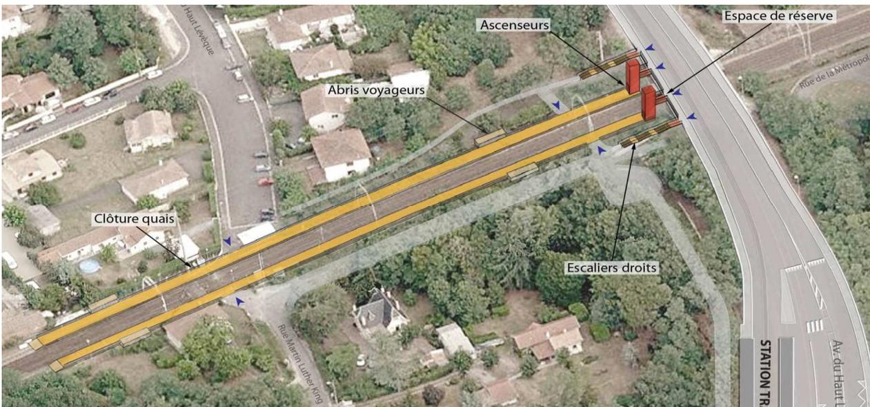
Figure 3 : Plan des aménagements de quai et de la traversée des voies piétonnes à la halte Alouette-France à Pessac
