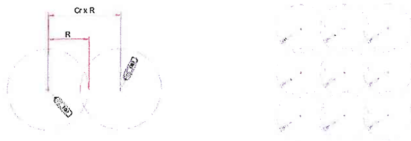
Figure 8 - Recouvrement des cercles d'évitage
