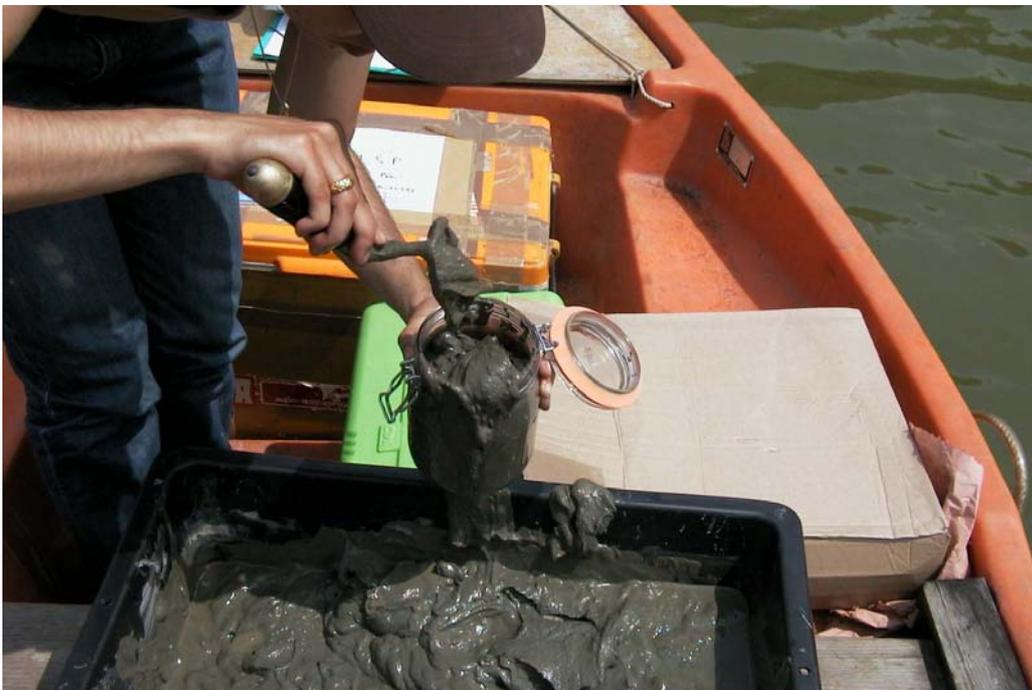
Figure n°F2.2\_10 : Prélèvement de sédiments à partir d'une embarcation (DIR Nord Est VNF)
