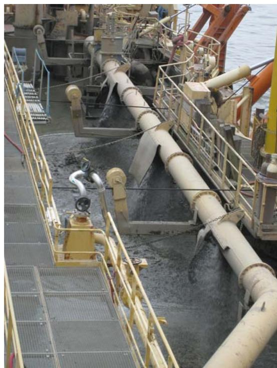
Figures n°F4.1\_6a et F4.1\_6b : (à gauche) détail de la drague «Ronceray» du GPMR en marche, des bossoirs (bras à gauche de la photo) et mise à l'eau de l'élinde (outil à droite de la drague) ; (à droite) remplissage du puits durant le dragage (2011, Solène Gaillard)
