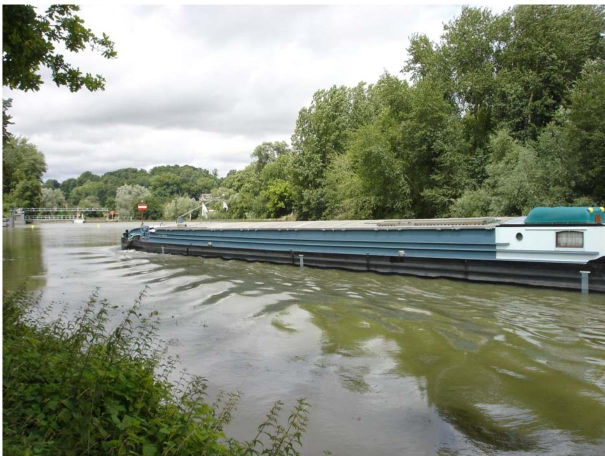
Figure n°F2.2\_1 : Exemple de batillage lors du passage d'une péniche sur l'Aisne au niveau du barrage de Carandeu (2007, CETMEF)
