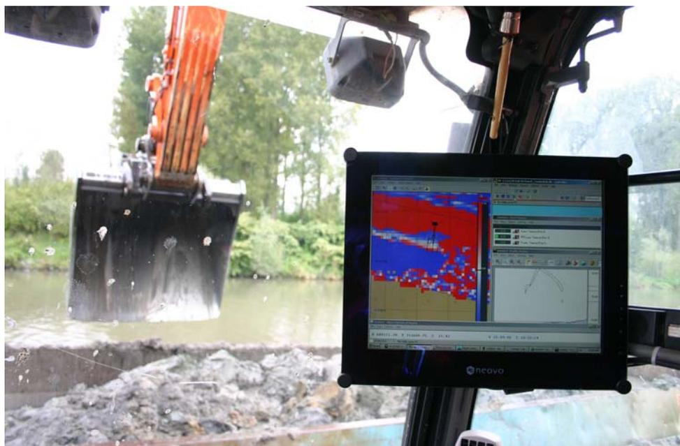
Figure n°F4.2\_4 : GPS embarqué dans pelle sur ponton (2007, DIR Nord Pas-de-Calais)
