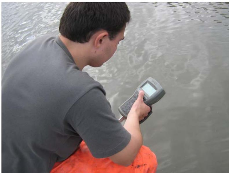
Figure n°F4.2\_3 : Mesure de la conductivité sur chantier (2007, DIR Nord Pas-de-Calais)
