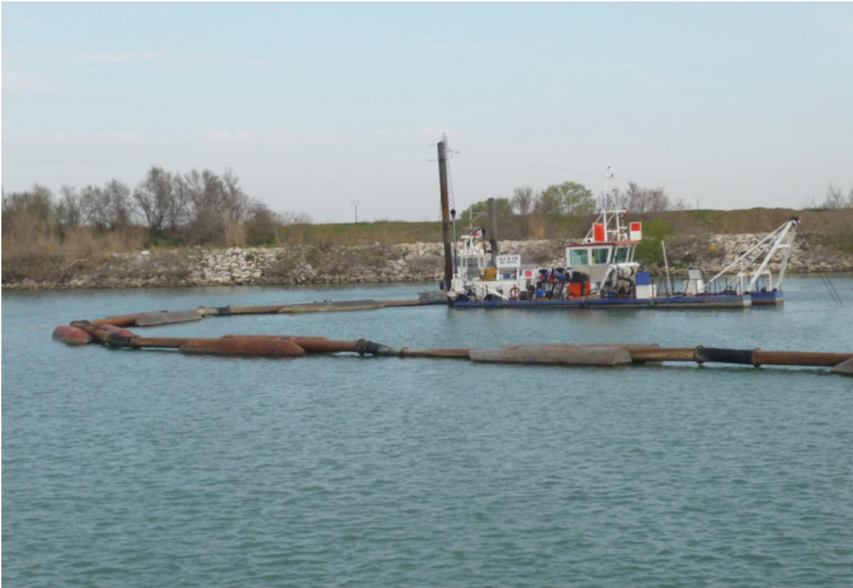
Figure n° F 4.1\_1 : dragage aspiratrice avec sa conduite de restitution, Barcarin sur le delta du Rhône (2009, CNR)
