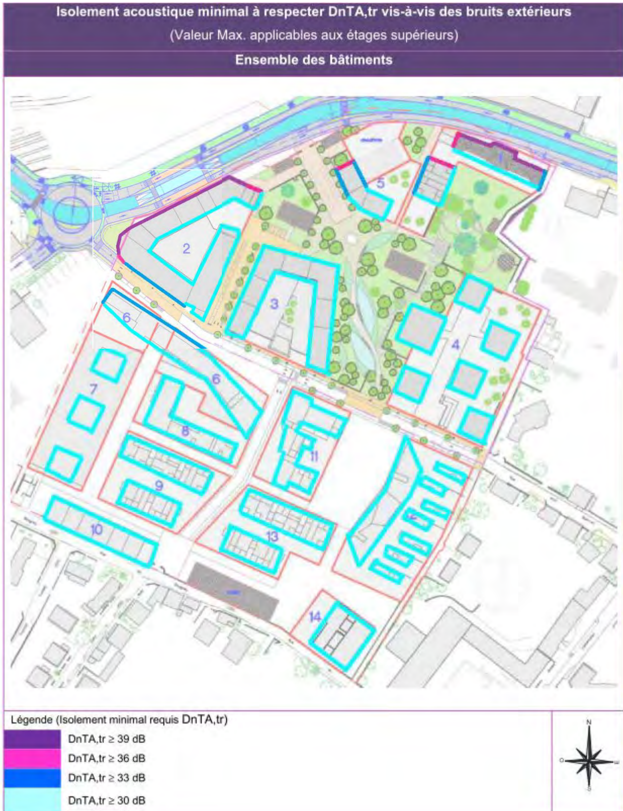
Figure 48 Isolement acoustique conseillé DnTA, tr vis-à-vis des bruits extérieurs (ensemble des flux de véhicules existants et projetés)
