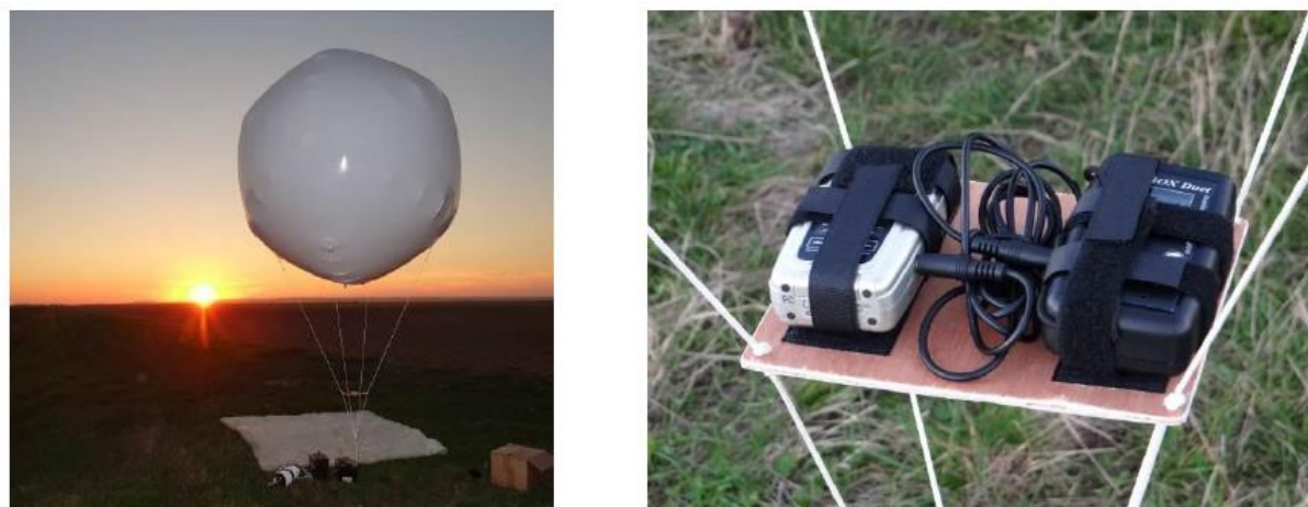
Ballon TPU gonflé à l'hélium équipé d'un dispositif de détection
