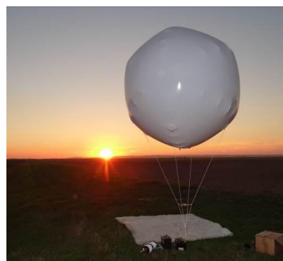
Ballon TPU gonflé à l'hélium équipé d'un dispositif de détection
