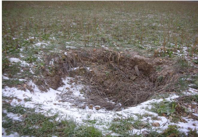
Fig. 11 : évolution d'un puits de marnière (LRPCA)
