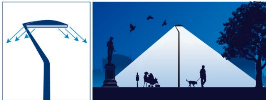
Illustration schématique du rendu d'éclairage du modèle de candélabre « Lanterne CitySoul gen2 » choisi pour le projet « Galaxie IV »
