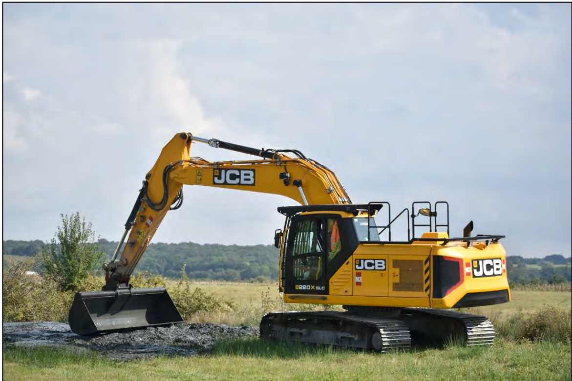
Photo 18 : Pelleteuse en train de régaler avec le godet. © Quentin Esnault
