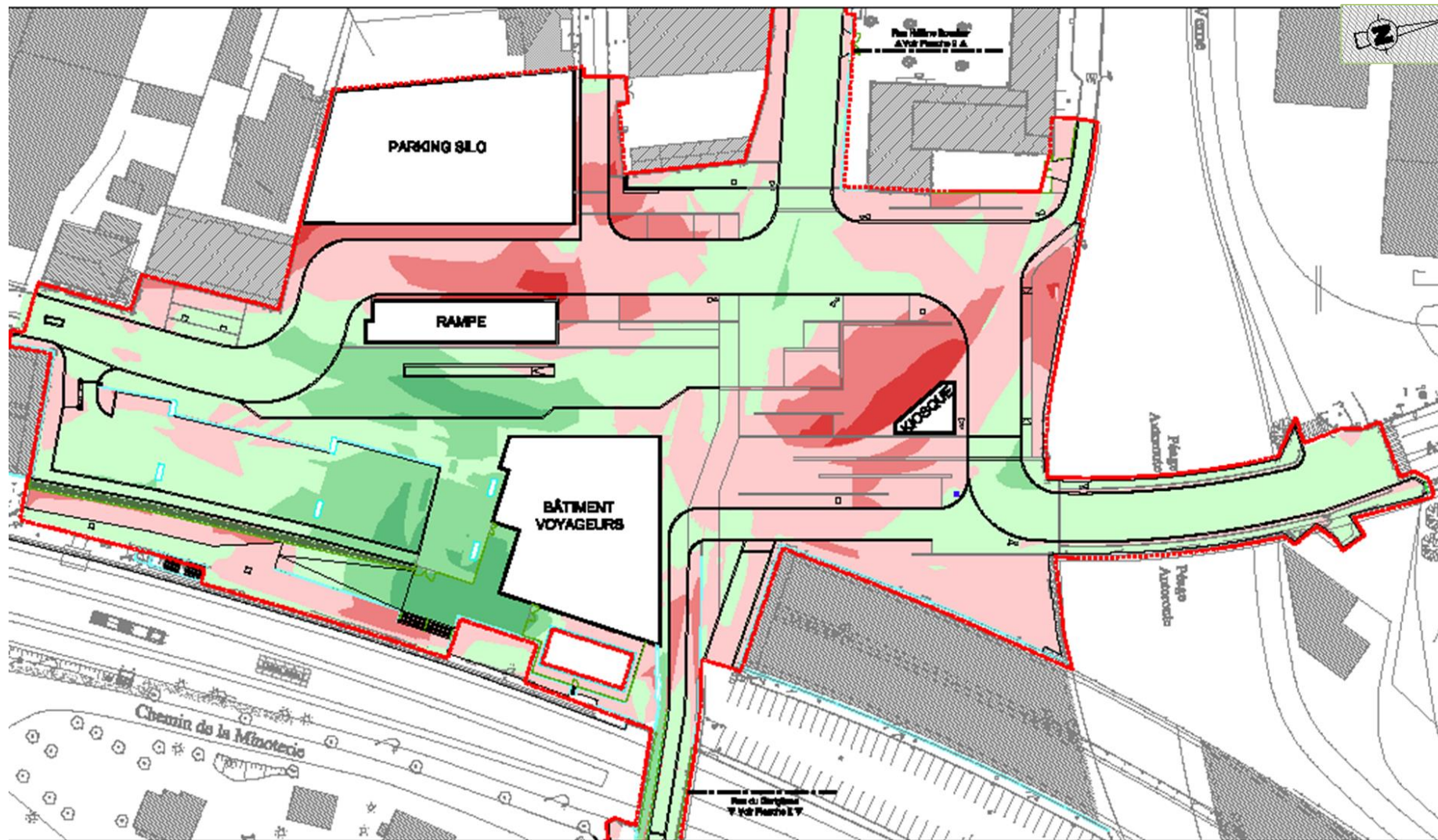
Figure 171 : Localisation des remblais – déblais (AREP)
