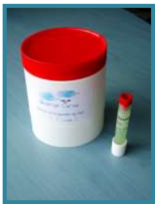
Figure 1 : Échantillonneur passif pour le dioxyde d'azote (NO 2 ) et sa boîte de protection contre les intempéries (Source : Qualitair Corse)
