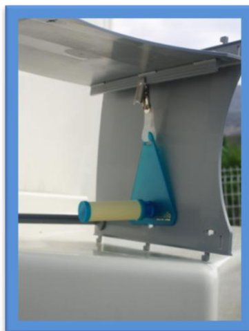
Figure 11 : Échantillonneurs passif pour les BTEX installé dans une boîte de protection contre les intempéries (Source : Qualitair Corse)
