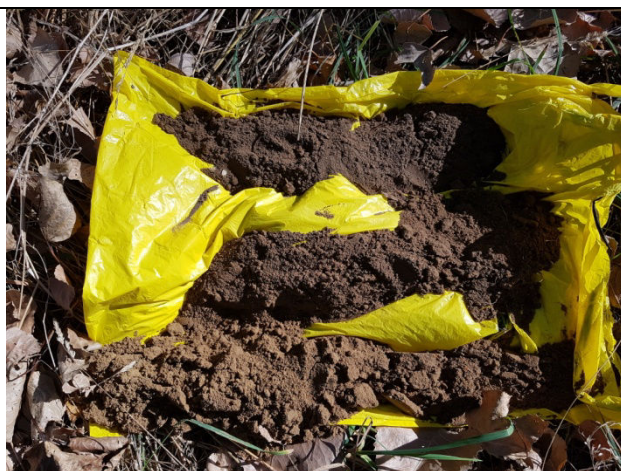
▲ Photographie n°3-02 : Carotte prélevée, déployée avec des traces d'hydromorphie qui sont assez marquées à partir de 60 cm de profondeur.
