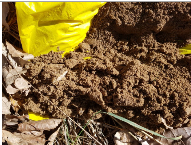
▲ Photographie n°3-04 : Traces d'hydromorphie qui sont assez marquées à partir de 60 cm de profondeur.
