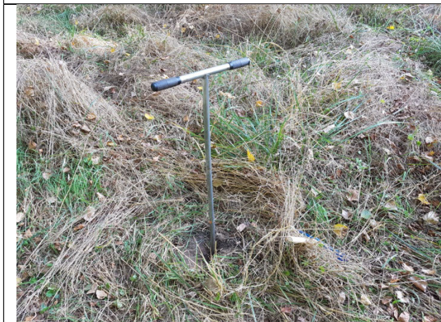
▲ Photographie n°1-03 : Tarière utilisée pour réaliser le sondage n°1.
