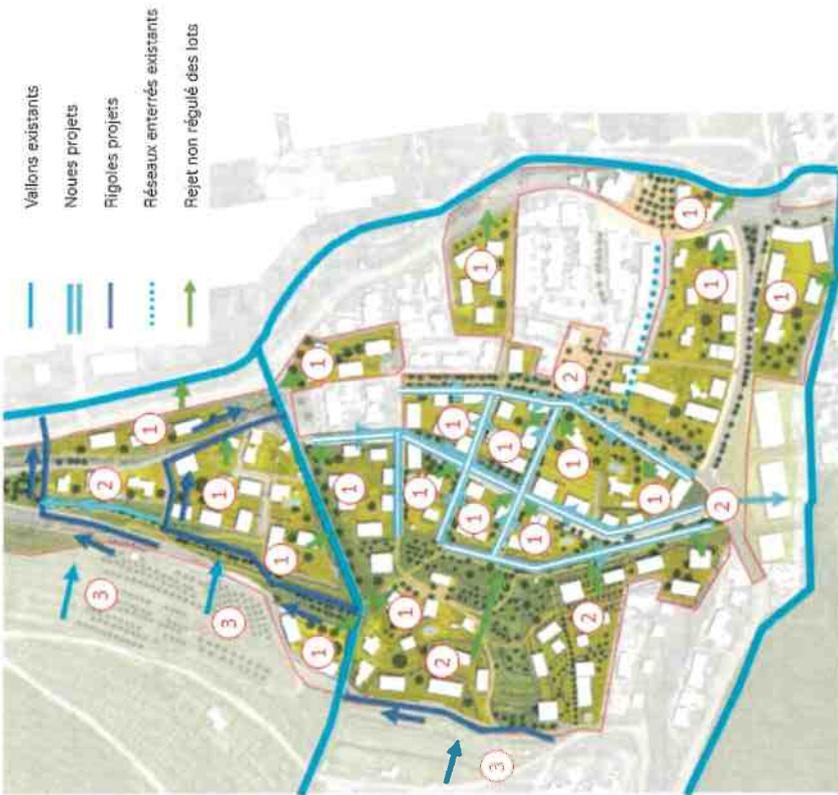
Secteur Nord : Conservation de l'écoulement du BVN grâce à une rigole (source : UrbanWater)
