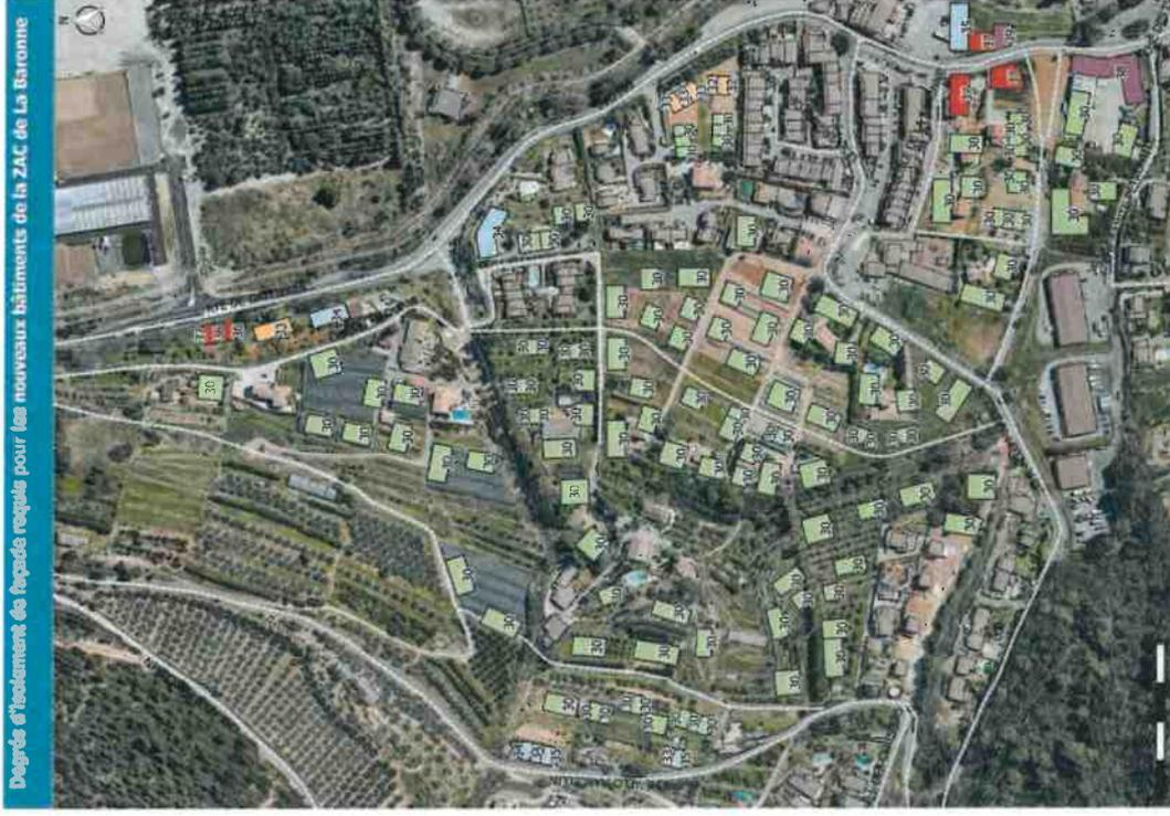
Figure 16 : Carte des degrés d'isolement de façade requis pour les futures constructions
