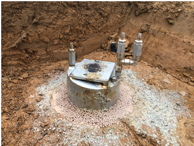
Etanchéité autour de l'infiltromètre (billes de Duranite), essai 3
