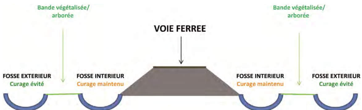
Figure 53 : Schéma de principe de drainage de la ligne ferroviaire du Bec d'Ambès, avec fossés curés et fossés évités. Coupe transversale (Source Simethis).
