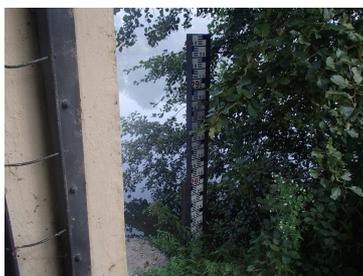
**Figure 3-1 : Echelle sous la passerelle**
