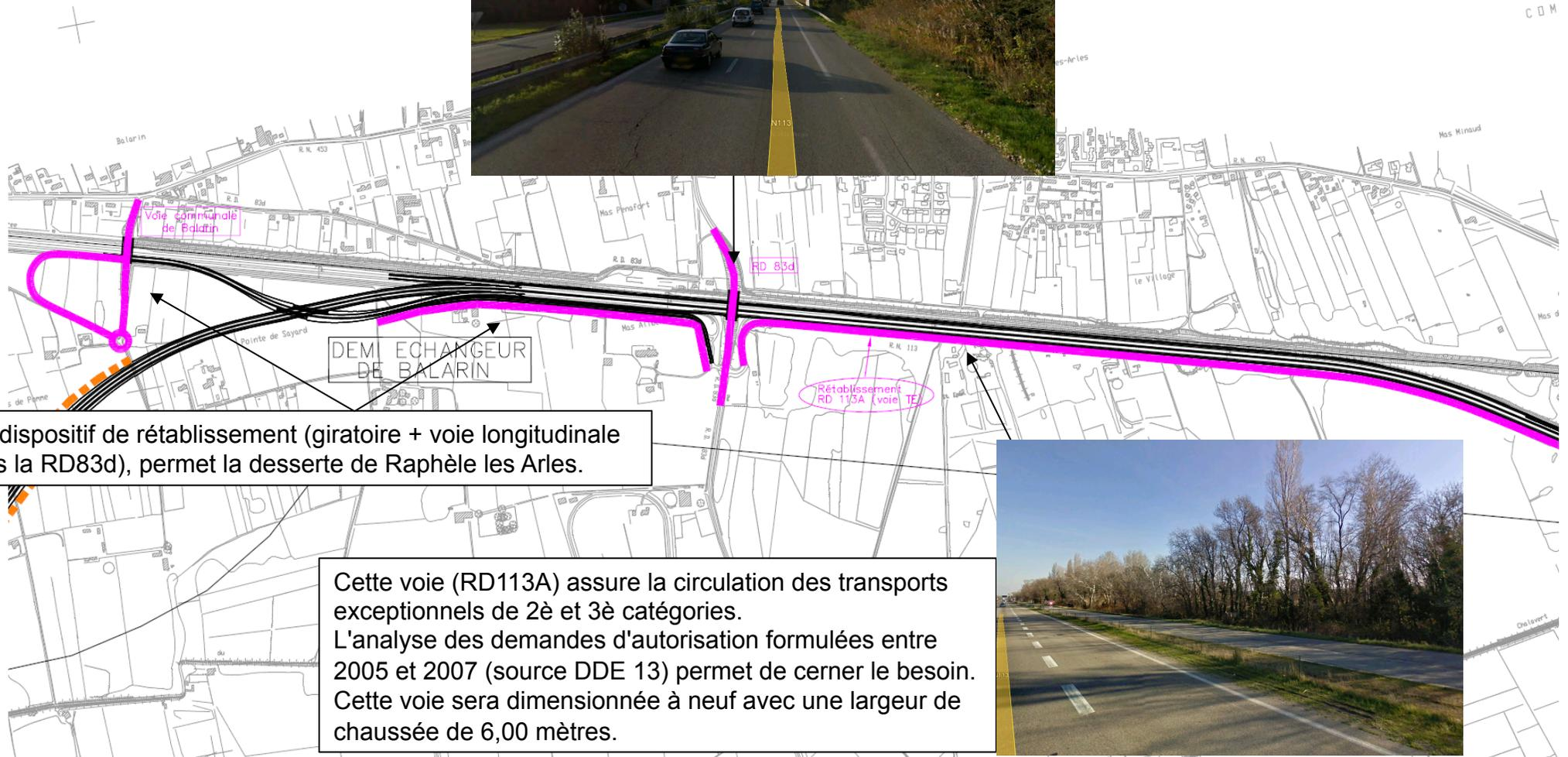
Ce dispositif de rétablissement (giratoire + voie longitudinale vers la RD83d), permet la desserte de Raphaële les Arles.
