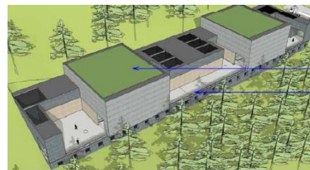
Toitures : Terrasses végétalisées Garde-corps/garde-roues maçonné
