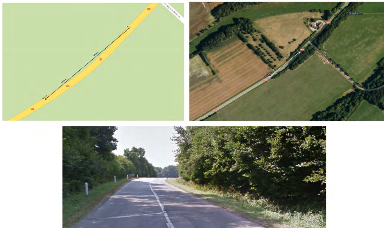
Illustration 127 : Visibilité dans le virage du PR 19+200 au PR 19+100 (source: Google earth, maps et Streetview)
