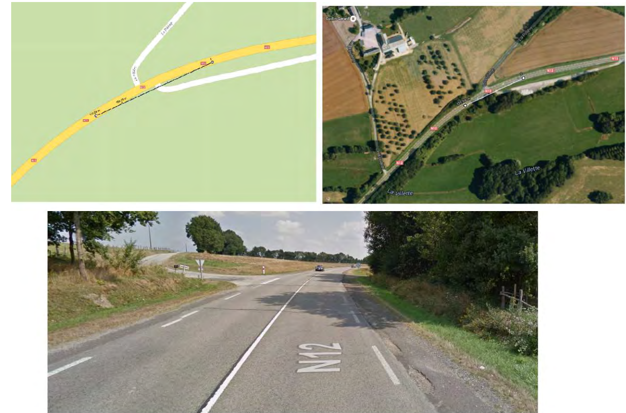
Illustration 128 : Visibilité dans le virage du PR 18+700 au PR 18+400 (source: Google earth, maps et Streetview)
