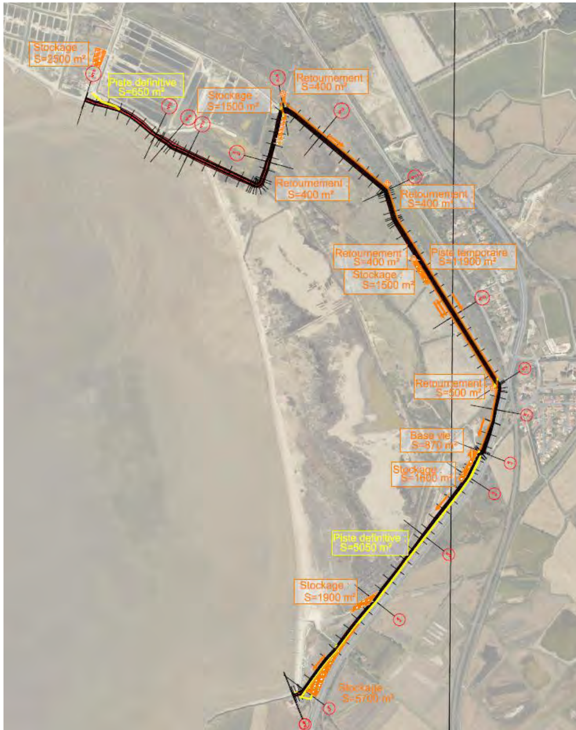
Figure 16 : Localisation des installations de chantier, pistes d'accès, zones de stockage et retournement en phase chantier
