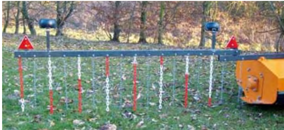
Exemple de barre d'effarouchement (source : Machinisme agricole et faune sauvage. Faune Sauvage. N° 291, 2e trimestre 2011)
