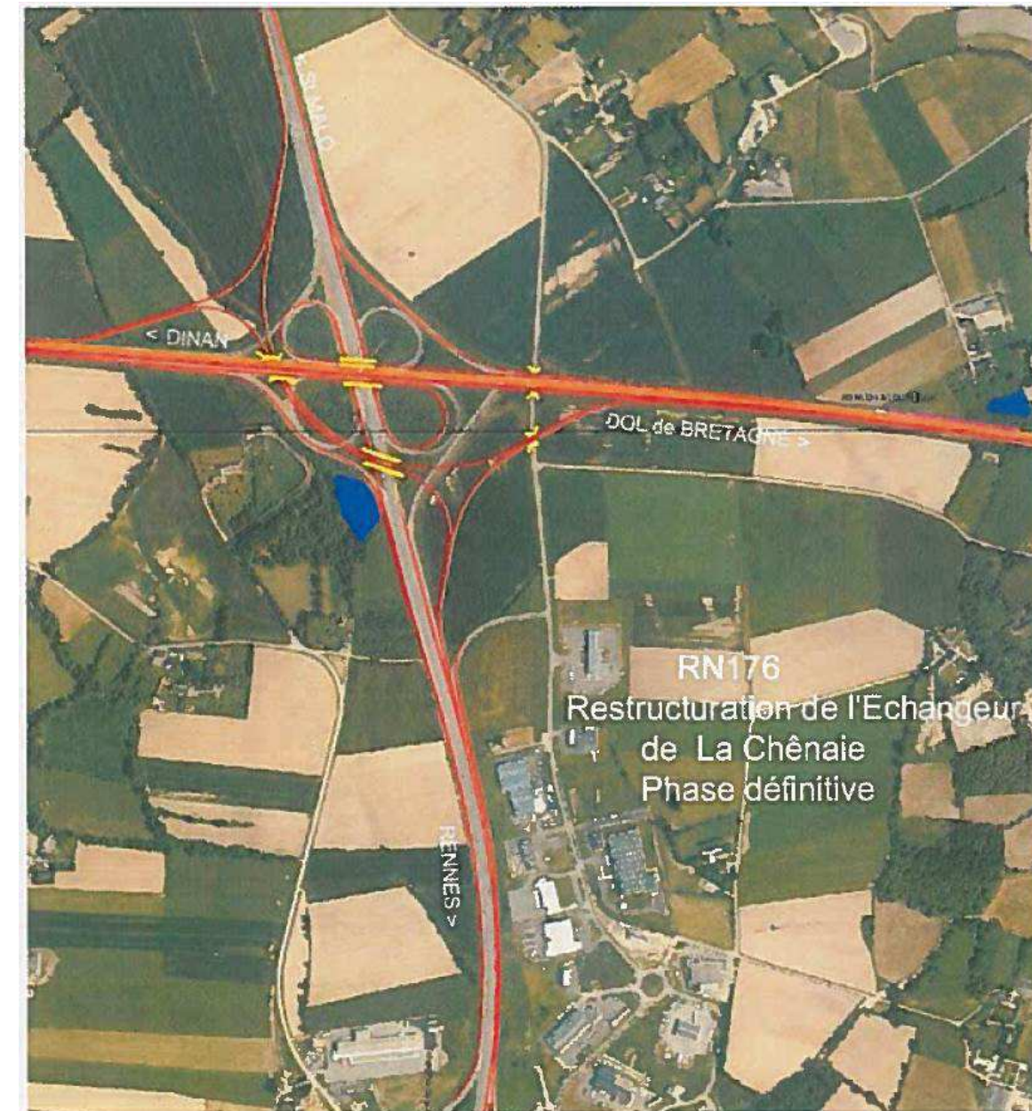
Figure 93 : L'échangeur de la Chênaie dans sa configuration définitive (source DREAL)
