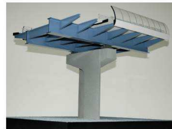
Maquette du viaduc sur la Maine avec écrans acoustiques transparents
