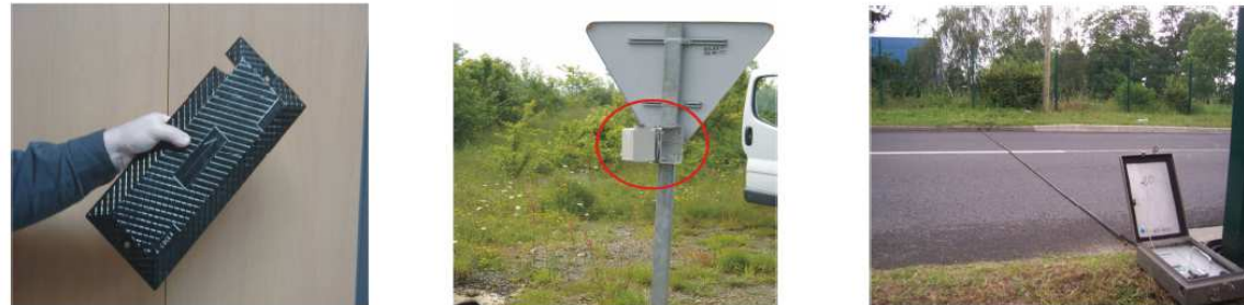
Figure 124 : Exemple de compteurs temporaires
