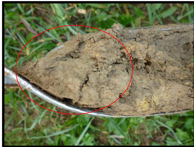
Traces d'hydromorphie observées lors d'un des sondages
