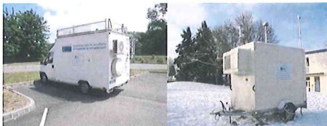
Figure 4 : Camion laboratoire et remorque appartenant au dispositif mobile de surveillance de la qualité de l'air d'ATMO FC
